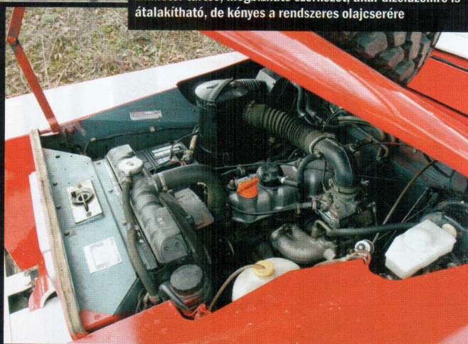
Sárga fényszóróival le sem tagadhatná francia származását a Riviéráról Budapestre került kocsi. A négyhengeres benzínmotor tartós, megbízható szerkezet, akár dízelüzemre is átalakítható, de kényes a rendszeres olajcserére
